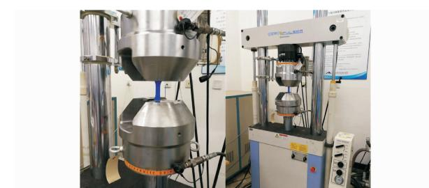
图 4 拉伸实验设备(液压伺服)和样件
