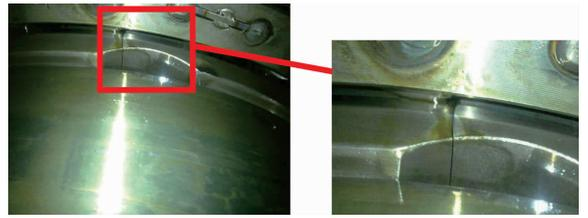
图 21 轴承内圈裂纹故障
