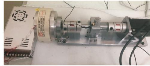
图 10 滚动轴承振动测试台
