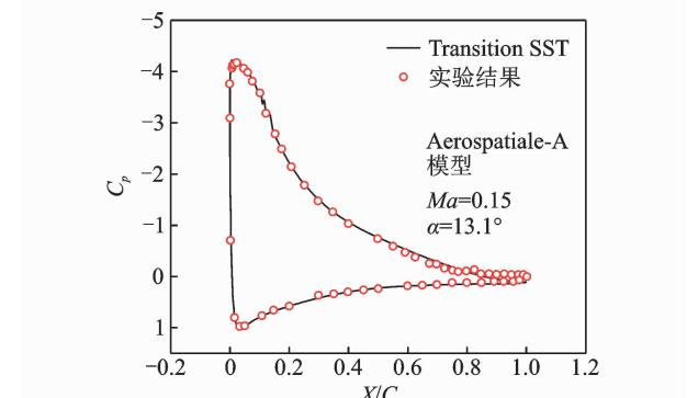
图 4 Aero-spatiale-A 翼型压力系数仿真值与实验值的比较
