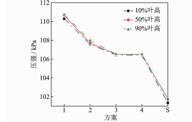
图 6 动叶表面最大气动载荷
