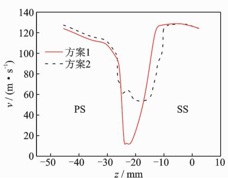
图 9 直尾缘与锯齿尾缘相同展向位置处的尾迹型面
