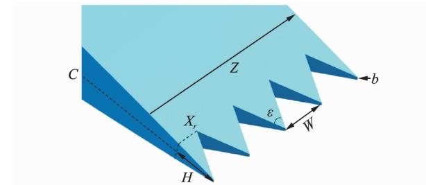
图 1 尾缘锯齿的结构参数
