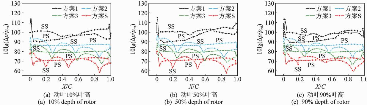
图 7 动叶表面气动载荷波动幅值分布
