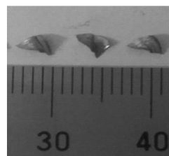
(b) 低频振动辅助钻削的切屑
