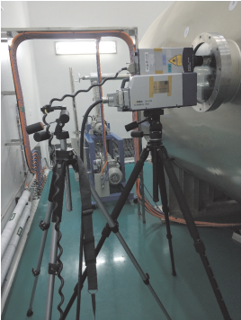
图 4 单点式激光测振仪和扫描式激光测振仪
