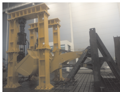
图6 LW900K装载机工作装置应力标定试验台
