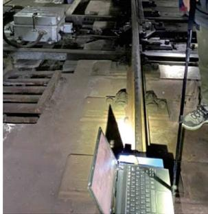
图 2 钢轨波磨测量现场
