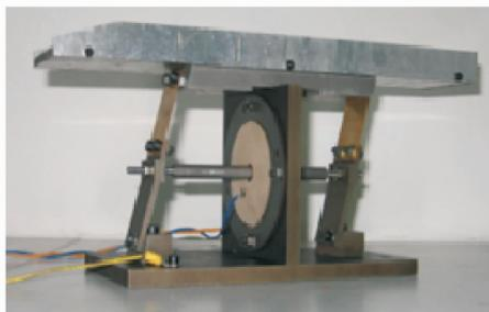
图8 振动送料器样机实物图
