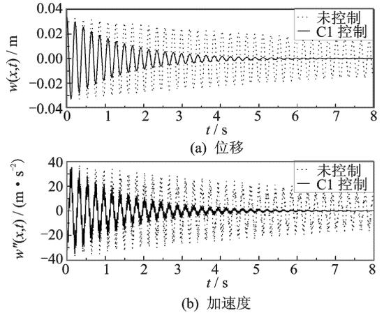
图12  $\tau=0.054\text{ s}$ 时C1方法控制自由振动的效果图
