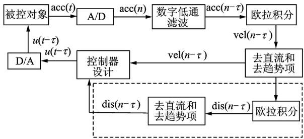
图1 传统时滞位移-速度反馈控制流程图
