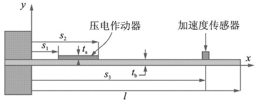
图3 粘贴有压电作动器和加速度传感器的智能梁示意图
