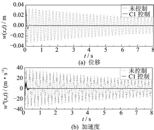
图11  $\tau=0.008\text{ s}$ 时C1方法控制自由振动的效果图
