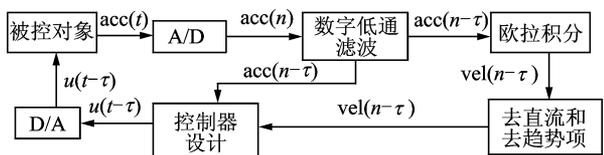
图2 速度-加速度时滞反馈控制流程图
