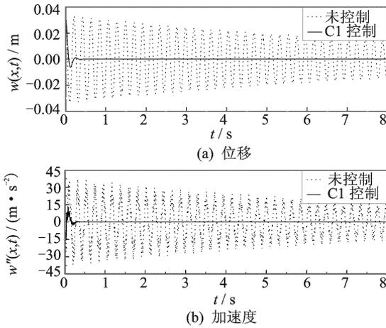
图9  $\tau=0.007\text{ s}$ 时C1方法控制自由振动的效果图
