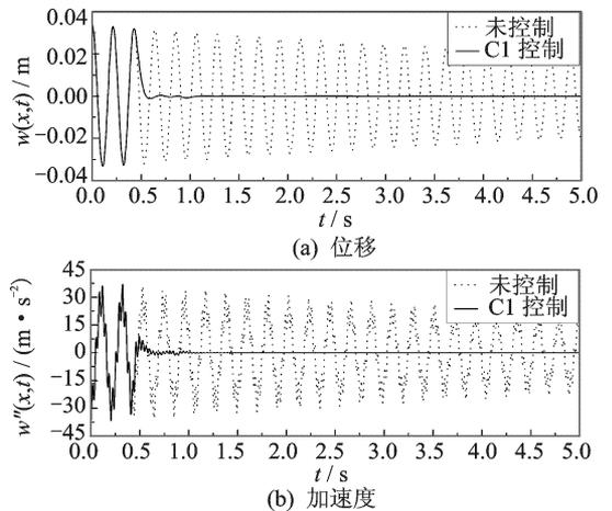
图13  $\tau=0.426\text{ s}$ 时C1方法控制自由振动的效果图
