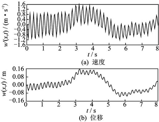
图5 滤波后的加速度信号经1次和2次数值积分结果
