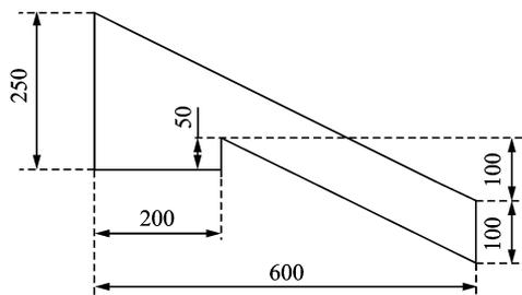
图2 薄板模型尺寸图(单位:cm)
