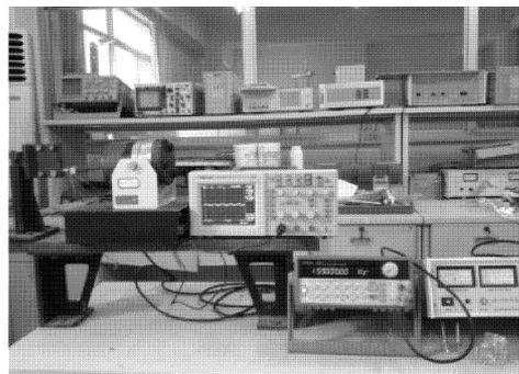
图5 V型压电换能器实验装置图
