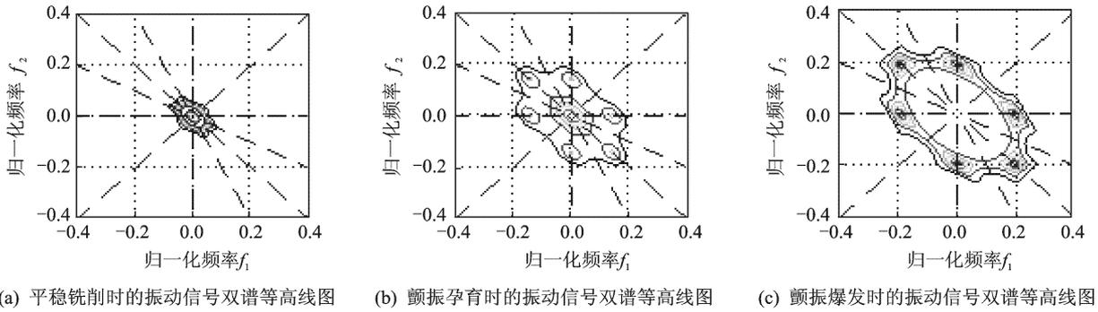
图4 不同铣削状态下振动信号的双谱等高线图( $n=3$  kr/min)
