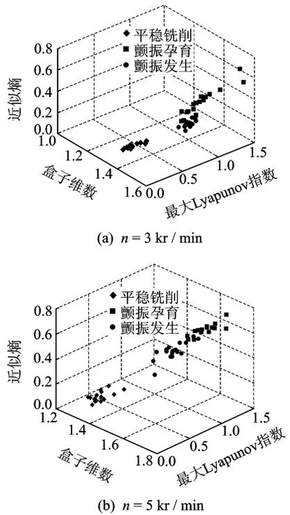
图8 铣削正常、铣削颤振孕育和铣削颤振的数据组在三维空间上的样本分布
