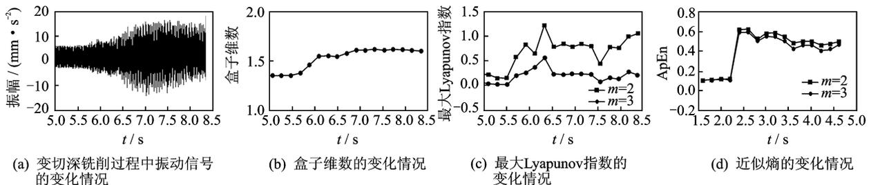
图7 变切深铣削过程中振动信号及非线性参数的变化情况( $n=5$  kr/min)
