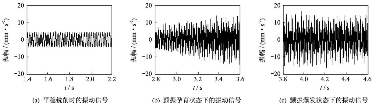
图3 变切深铣削振动信号( $n=3$  kr/min)
