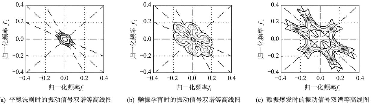
图5 不同铣削状态下振动信号的双谱等高线图( $n=5$  kr/min)
