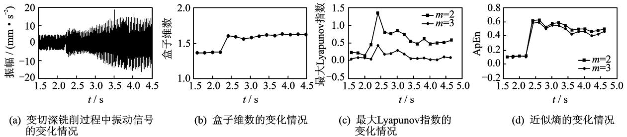
图6 变切深铣削过程中振动信号及非线性参数的变化情况( $n=3$  kr/min)
