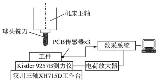
图1 测试系统的结构示意图
