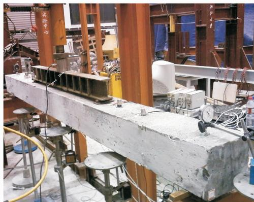
图1 钢筋混凝土梁损伤试验装置
