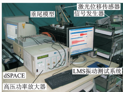
图2 垂尾模型抖振响应压电主动控制实验现场
