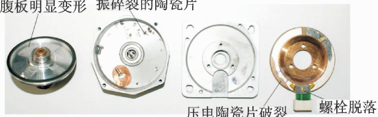
图 11 锤击实验后的拆分组件
