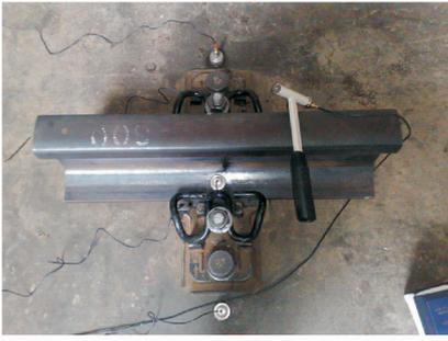
图 2 安装了钢轨的 WJ-7 扣件系统
