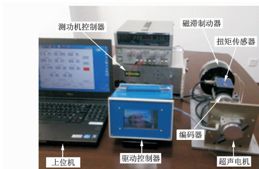
图 3 超声电机运行特性测试系统
