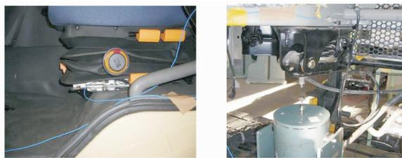
图6 振动响应试验传感器与激振器布置
