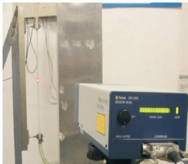
图 3 输流管道实验中的激光振动测试
