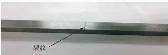
图 2 实验裂纹梁
