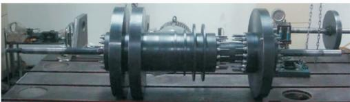
图 3 模型拉杆转子实物图
