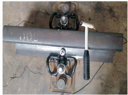
图2 安装好的轨道结构 Fig.2 The mounted track structure
