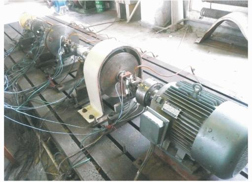
图 5 三跨双圆盘转子系统试验台
