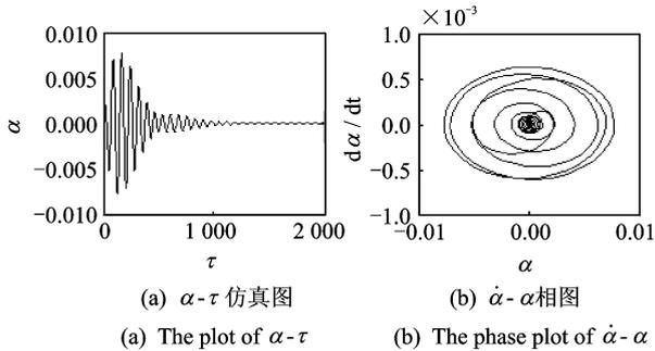
图 1 机翼颤振仿真图( $V=12.247\ 453$ )
