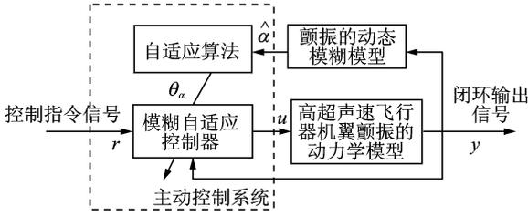
图4 高超声速机翼颤振的主动控制系统
