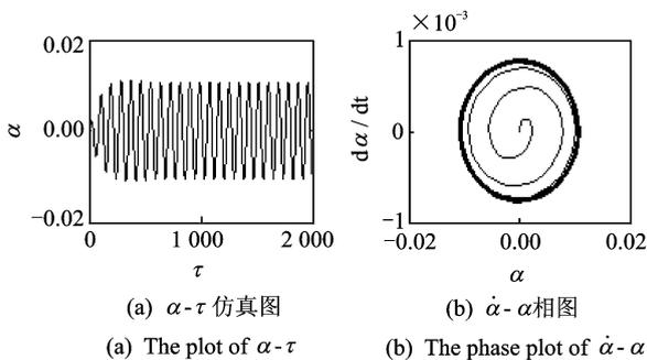
图 2 机翼颤振临界状态仿真图( $V=V_F=13.887\ 453$ )
