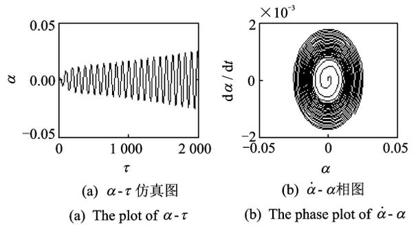
图 3 机翼颤振仿真图( $V=14.121\ 205$ )
