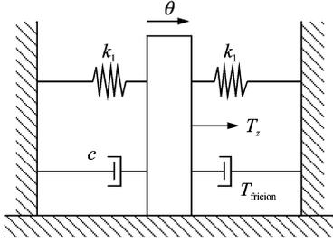
图1 轧机主传动位移延时反馈力学模型
