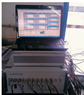
图3 现场风压数据采集(方案1)
