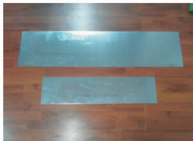
图 1 GB/T3190-96 的铝板试验件
