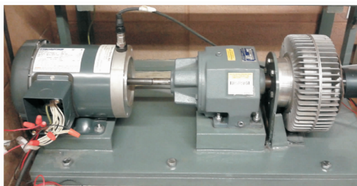
图5 电机故障实验台
