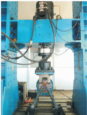
图 7 V 型推力杆的装夹状态
