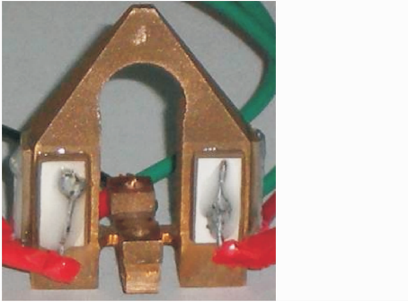
图 4 塔形定子样机
