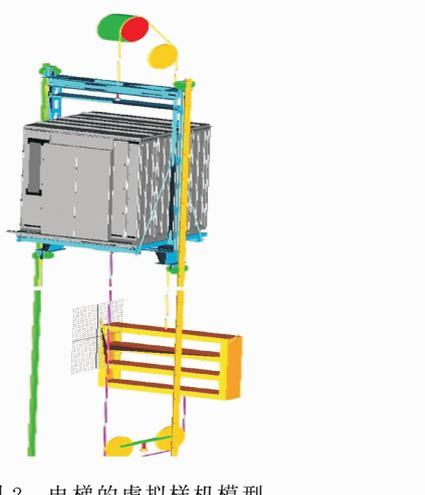
图 2 电梯的虚拟样机模型
