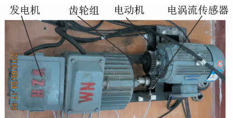
图 3 风电机组齿轮故障模拟试验台照片
