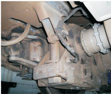
图 2 齿轮箱测点传感器布置示意图
