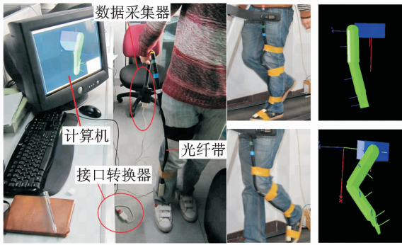
图 8 检测人体下肢运动意图的光纤带系统图
