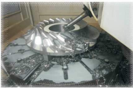
图 1 五轴加工中心加工叶轮
