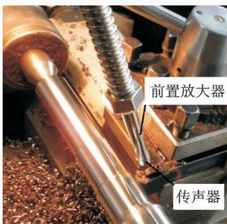
图6 切削声信号的采集
