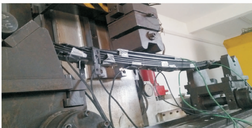
图7 钢板弹簧刚度及强度特性试验
