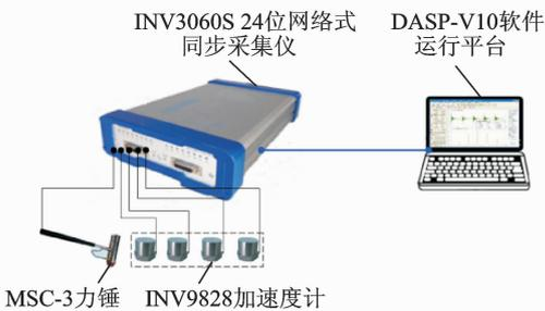
图 1 模态测试系统框图
