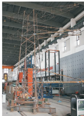
图2 输电塔线体系的实验室建模
