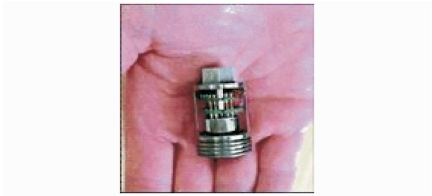
图 9 Sandia 国家实验室的加速度测试仪 Fig. 9 Acceleration tester developed by Sandia National Laboratory
