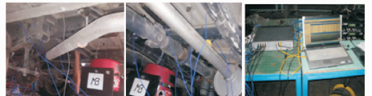
图 4 激振器布置和 LMS 测试系统
