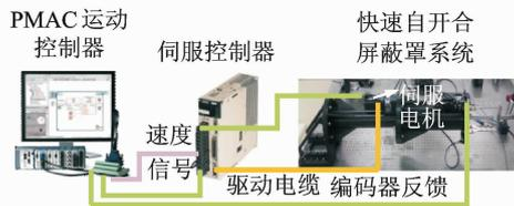
(b) 屏蔽罩系统运动控制示意图
