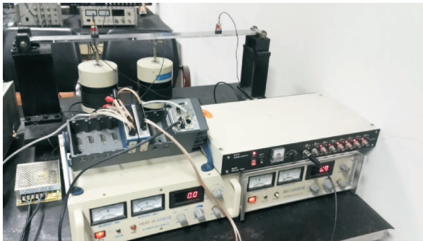
图9 简支梁振动主动控制试验现场图
