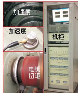
图 1 轧机耦合振动在线监测系统
