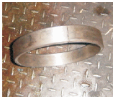
图9 轴承外圈断裂实物图
