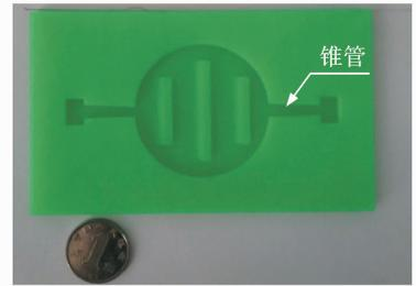
(b) 锥管坡面腔底无阀压电泵泵体照片
