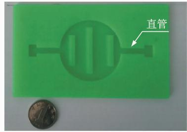
(a) 坡面腔底无阀压电泵泵体照片
