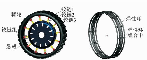
图 1 机械弹性车轮结构示意图
