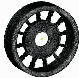
图 3 车轮有限元网格模型
