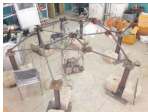
图 12 移除杆件 7 后结构破坏照片 Fig. 12 Damage picture of removing element 7
