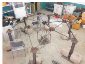
图 11 移除杆件 1 后结构破坏照片 Fig. 11 Damage picture of removing element 1
