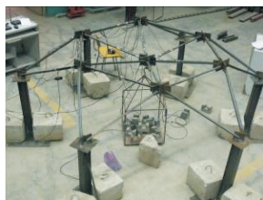
图 10 原始结构破坏照片 Fig. 10 Damage picture of original structure
