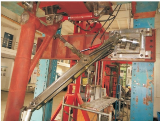
图6 起落架收放试验图
