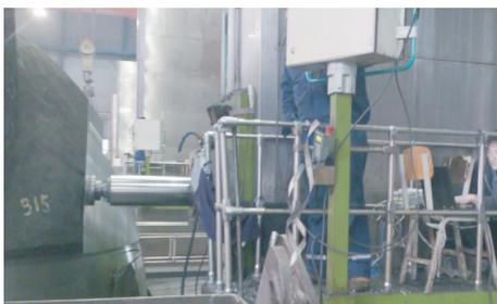
图 1 现场大悬伸铣削实验
