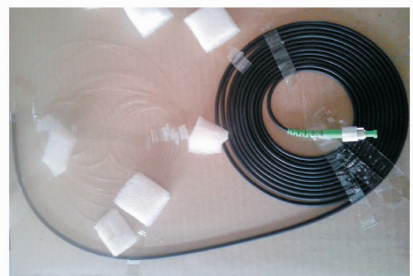
图 6 12 点光纤光栅串及铠装光缆
